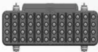
Томограф для бетона A1040 MIRA представляет собой полностью автономный измерительный блок для сбора и томографической обработки полученных данных. Измерительный блок содержит матричную антеннную решетку из 48 низкочастотных широкополосных преобразователей
