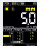
Предназначен для оперативного определения толщины объекта контроля, распределения перед записью результатов измерений по группам, просмотра на экране записанных в память прибора результатов измерений, а также для коррекции записей, путем проведения повторных измерений с записью данных в корректируемые ячейки.
