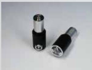
Преобразователи с сухим точечным контактом для реализации сквозного и поверхностного прозвучивания объекта контроля:
