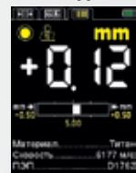
Предназначен для оперативного определения отклонения толщины объекта контроля от установленного номинального значения. Этим режимом удобно пользоваться, когда в нормативных документах указаны допустимые отклонения от нормы.
