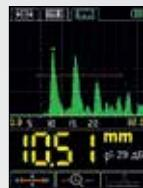
Предназначен для проведения измерений с выводом на дисплей прибора сигналов в виде А-Скана. Режим позволяет исключить неточности в измерениях, вызванные удвоением показаний. Возможны четыре способа измерений: первое превышение сигналом строба, положение максимума в стробе, между двумя сигналами и АКФ по стробу. Выбор способа измерения «между двумя максимумами» позволяет осуществлять толщинометрию металла через пластиковые (полиэтиленовые) и лакокрасочные покрытия без зачистки.
