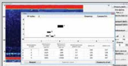
По окончании сканирования трубы оператор выделяет аномальные области, на основе которых формируется отчет с координатами обнаруженных дефектов и схемой их расположения на труbe.
