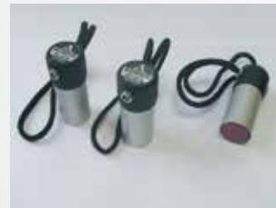
Преобразователями с жидкостным контактом для сквозного прозвучивания:
