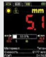
Предназначен для оперативного определения толщины объекта контроля с оценкой принадлежности результата измерений заданному интервалу и критерию срабатывания автоматической сигнализации дефекта (АСД). Удобство работы обеспечивает: звуковая и виброндикация при выходе результата измерений за границы допустимых значений и графическое представление шкалы глубинометра.
