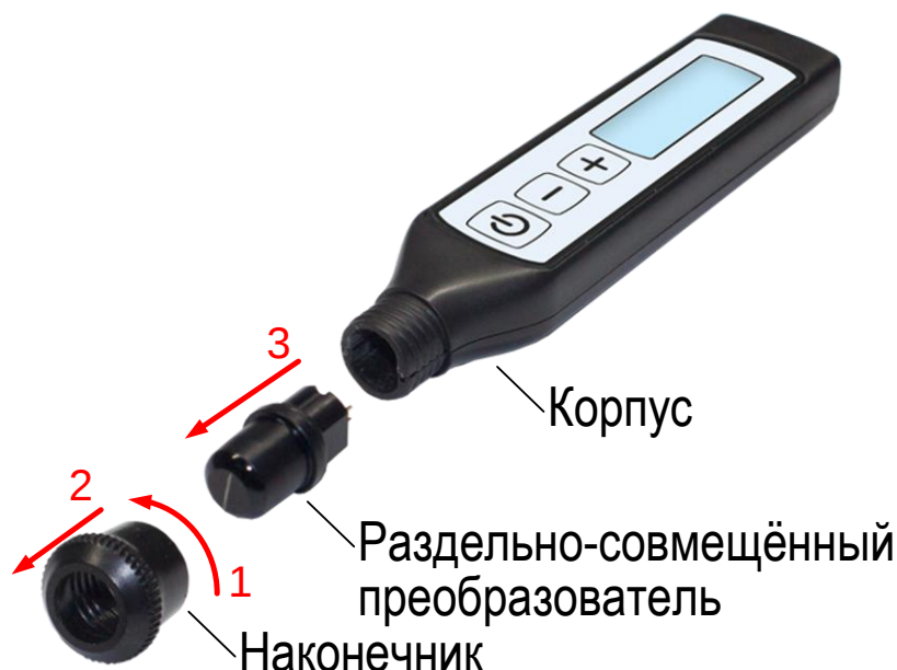
Рисунок 26 – Отсоединение раздельно-совмещённого преобразователя
