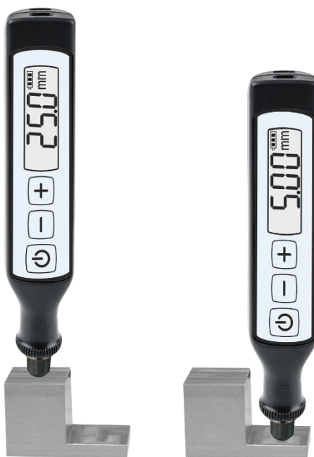
Рисунок 9 – Калибровка на образце UCB014
